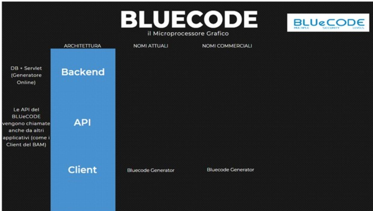
La Piattaforma che gestisce il BLUeCODE permette di generare BLUeCODE, sfruttando delle API che a loro volta interagiscono con il Backend. Viene gestita la generazione di BLUeCODE con e senza estrazione del template facciale.
